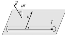
ЭДС индукции в прямом проводнике длиной  $l$ , движущемся со скоростью
